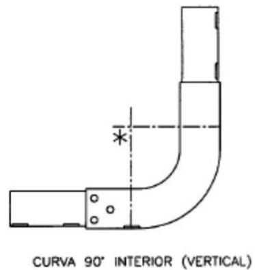
\* RADIO DE CURVATURA DE ACUERDO A LA CURVATURA PERMISIBLE DE LOS CABLES
