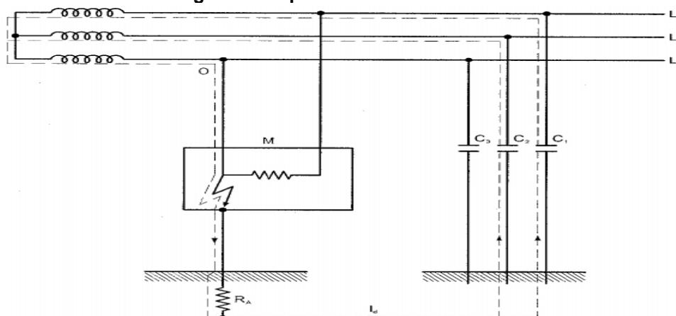
Figura 7. Esquema IT unido a tierra por impedancia Z y con las puestas a tierra de la alimentación y de las masas separadas.
